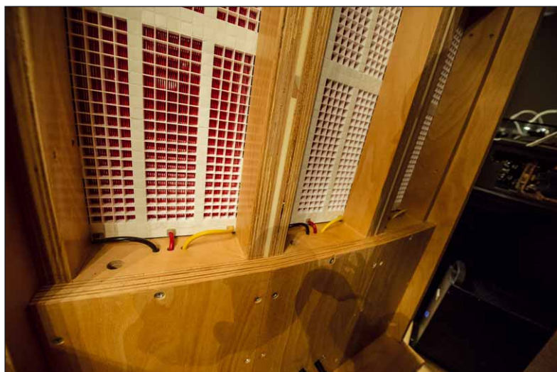
Hier erkennt man die Solidität der Rahmenkonstruktion. Durch die Öffnung links am Rand werden 42 Kilogramm Korund-Granulat eingefüllt
