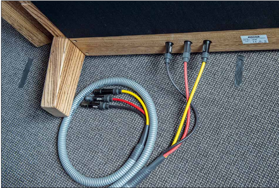
Drei Anschlussleitungen führen zum Schallwandler – zwei führen die NF-Signale, eines die Versorgungsspannung
