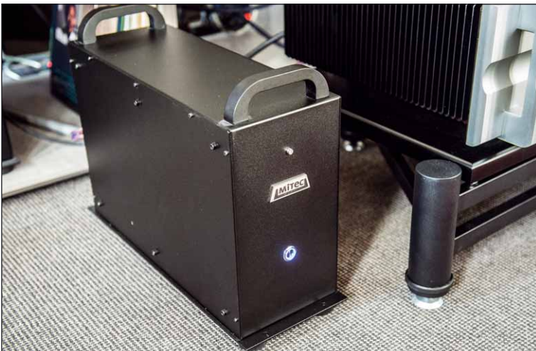
Die pragmatischen Metallgehäuse beherbergen die Versorgungseinheit und die mit aufwendigen Übertragern bestückte Frequenzweiche
