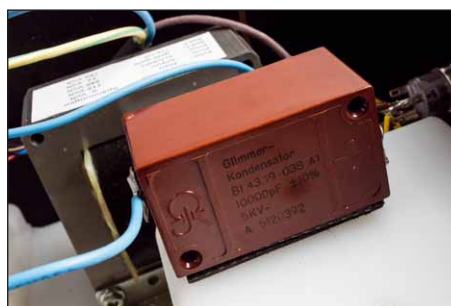
Dieser sündteure Glimmerkondensator koppelt die Ausgangssignale beider Übertrager
